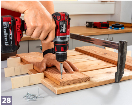
28 Die sechs Bretter rechtwinklig und mit 10 mm Abstand zwischen den Trittbrettern ausrichten und verschrauben.
